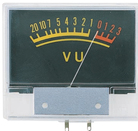
Figure 27: Quand l'aiguille d'un Vu-mètre atteint 0 dB, nous obtenons à la sortie de l'amplificateur la puissance maximale qu'il peut produire.
