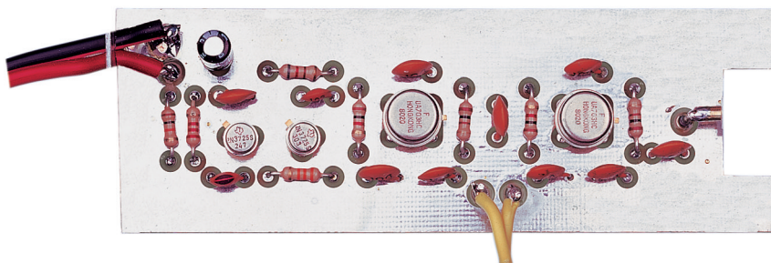
Figure 10: Photo d'un des prototypes de la platine du générateur de bruit - testeur de résonance. Le plan de masse étamé, côté composants, sert de blindage pour les pistes de l'autre face, côté soudures.
